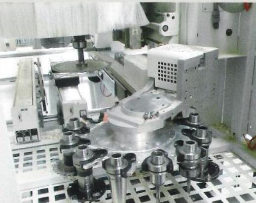
► Für all diejenigen, die eine hohe Anzahl an Werkzeugen benötigen, steht über das mitfahrende Tool Room mit 12 Werkzeugplätzen und bis zu zwei zusätzliche seitliche 10-fach Wechsler immer das passenden Werkzeug schnell zur Verfügung.
