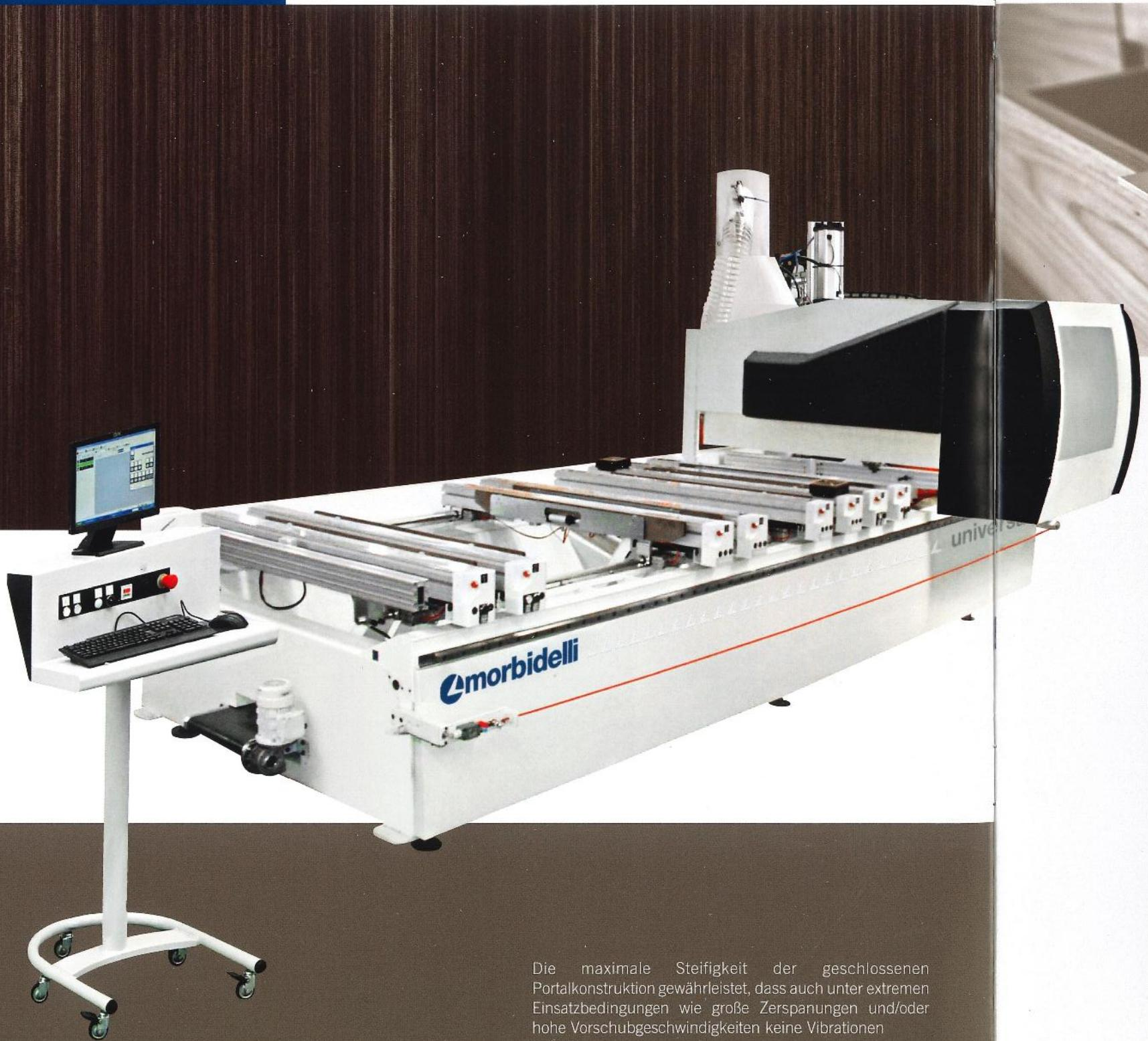
Die maximale Steifigkeit der geschlossenen Portalkonstruktion gewährleistet, dass auch unter extremen Einsatzbedingungen wie große Zerspanungen und/oder hohe Vorschubgeschwindigkeiten keine Vibrationen auftreten.
