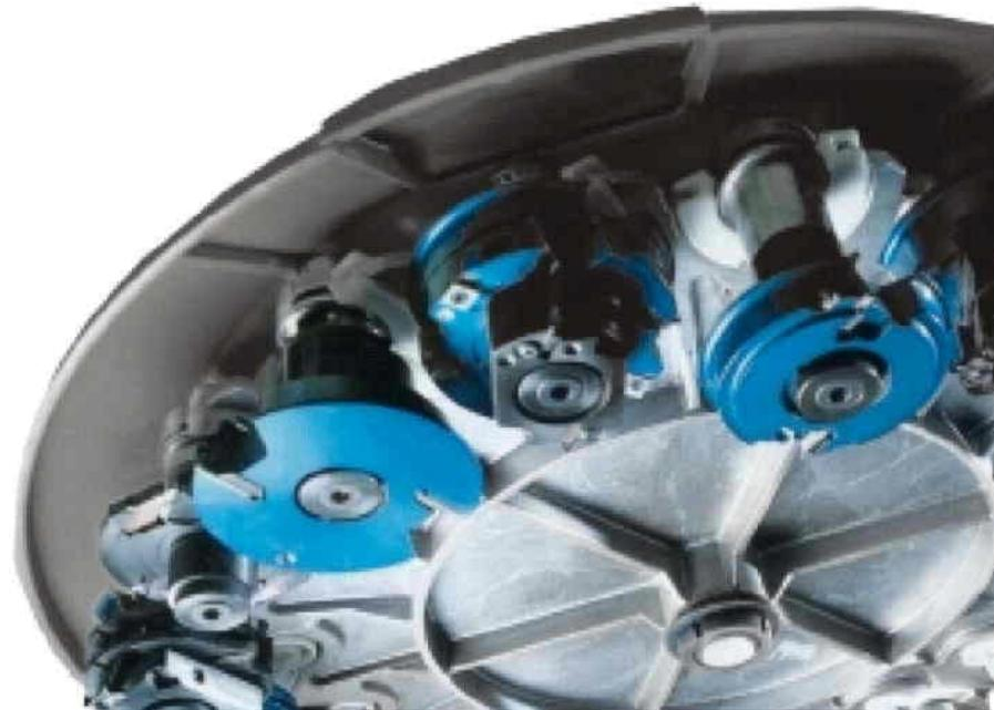
BOHRKOPF 17 SPINDeln, 4 SPINDeln HORIZONTAL
