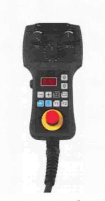
Mobile Steuereinheit zur Übertragung der Steuerbefehle zum Gebrauch nahe der Maschine.
