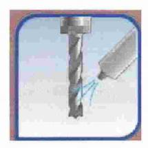
Ermöglicht die Zufuhr von Luftgebläse für die Werkzeugkühlung, während der Bearbeitung.
