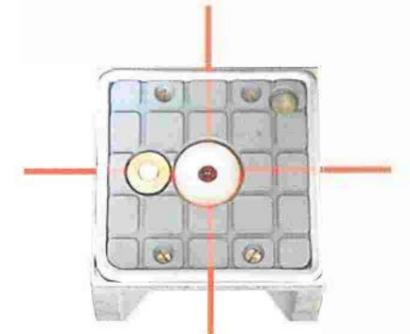
Saugerpositionierung mit Hilfe von Laserstrahl
