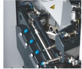
**Multifunktionsfräsaggregat e-motion Bündig- und Radienfräsaggregat Positioniergesteuert:**
