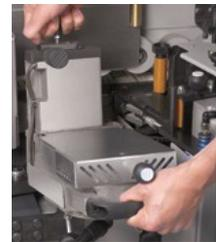
**Anpressaggregat e-motion pneumatisch einsetzgesteuert:**
