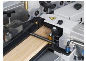
**Werkstückzuführung und Zuführlineal:**
