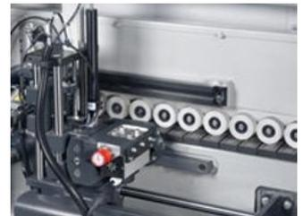
**2-Achs-motorisch-positioniergesteuertes Radienziehklingenaggregat inkl. pneumatischer Ausrückfunktion**
