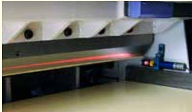
Der Laserstrahl zeigt deutlich die Schnittlinie für die optimale Furnierausnutzung an.
