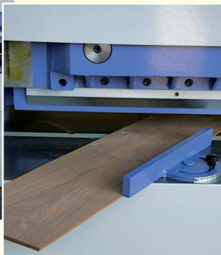
Vorrichtung für Winkelschnitt
