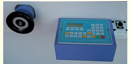
Masseingabe für Schnittbreite oder Streifenschnitt, automatische Anschlagverstellung, Schalter für automatischen Nachschnitt
