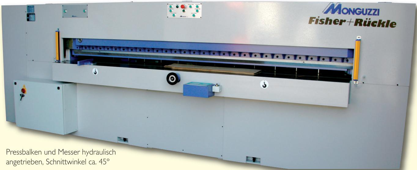
Pressbalken und Messer hydraulisch angetrieben, Schnittwinkel ca. 45°
